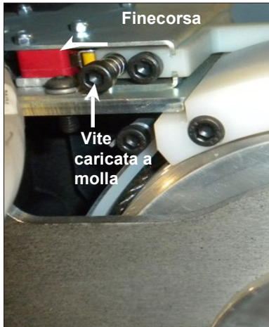
Fig. O. Posizionare la testa della vite esagonale e spingerla a fondo affinché non possa più muoversi.
