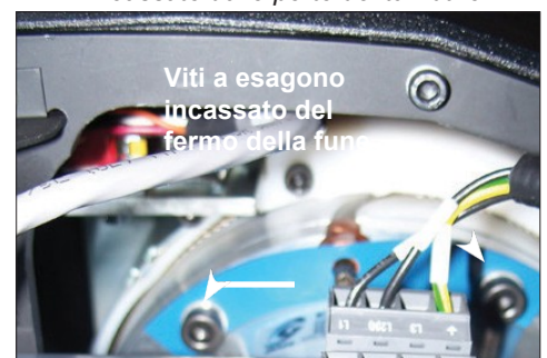
Fig. S. Rimuovere due viti a esagono incassato M6 dalle porte del tamburo.
