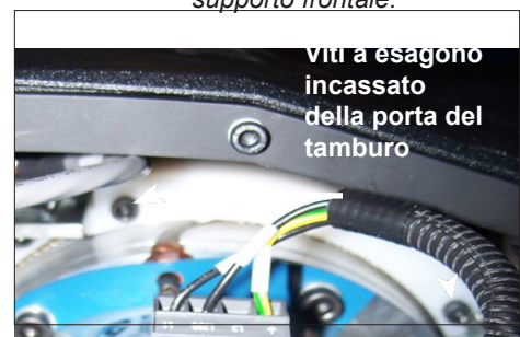
Fig. S. Rimuovere due viti a esagono incassato M6 dalle porte del tamburo.
