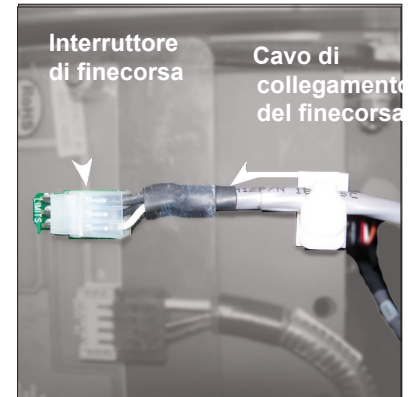
Figura O. Estrarre con cautela il filo grigio del finecorsa per disconnetterlo dal circuito stampato.
