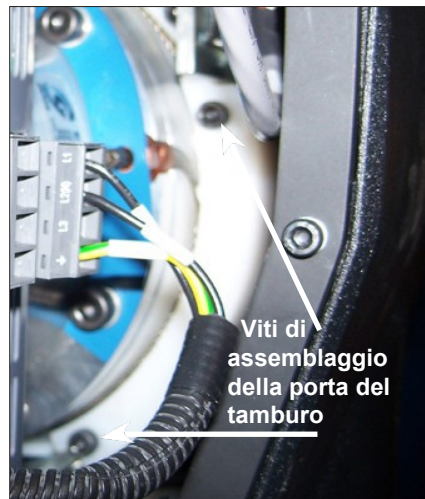
Diagramma R. Rimuovere le due viti a esagono incassato M6 dalle porte del tamburo.
