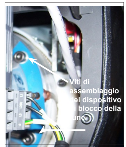
Figura S. Rimuovere le due viti a esagono incassato M8 e far scivolare l'estremità del cavo verso di voi.
